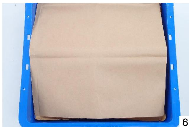
仕切り板によって多層に分かれている場合、1枚の気化性防錆紙のみでは、気化した防錆剤が容器内に均一に拡散しないため、各層に気化性防錆紙を置く必要があります。
